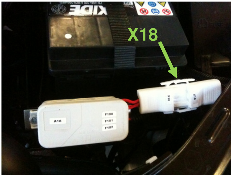
Stecker X18 vor der Bordbatterie im Motorraum.
